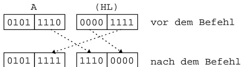
Die unteren 4 Bits der durch das Registerpaar HL adressierten Speicherstelle werden in die unteren 4 Bitstellen des Akkumulators übertragen und diese in die oberen 4 Bitstellen der durch das Registerpaar HL adressierten Speicherstelle.
