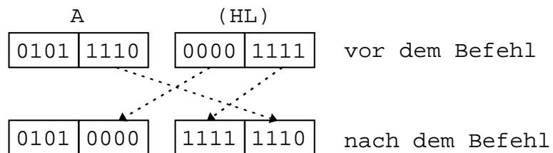
Die unteren 4 Bits der durch das Registerpaar HL adressierten Speicherstelle werden in die oberen 4 Bitstellen übertragen und diese ihrerseits in die unteren 4 Bitstellen des Akkumulators.
