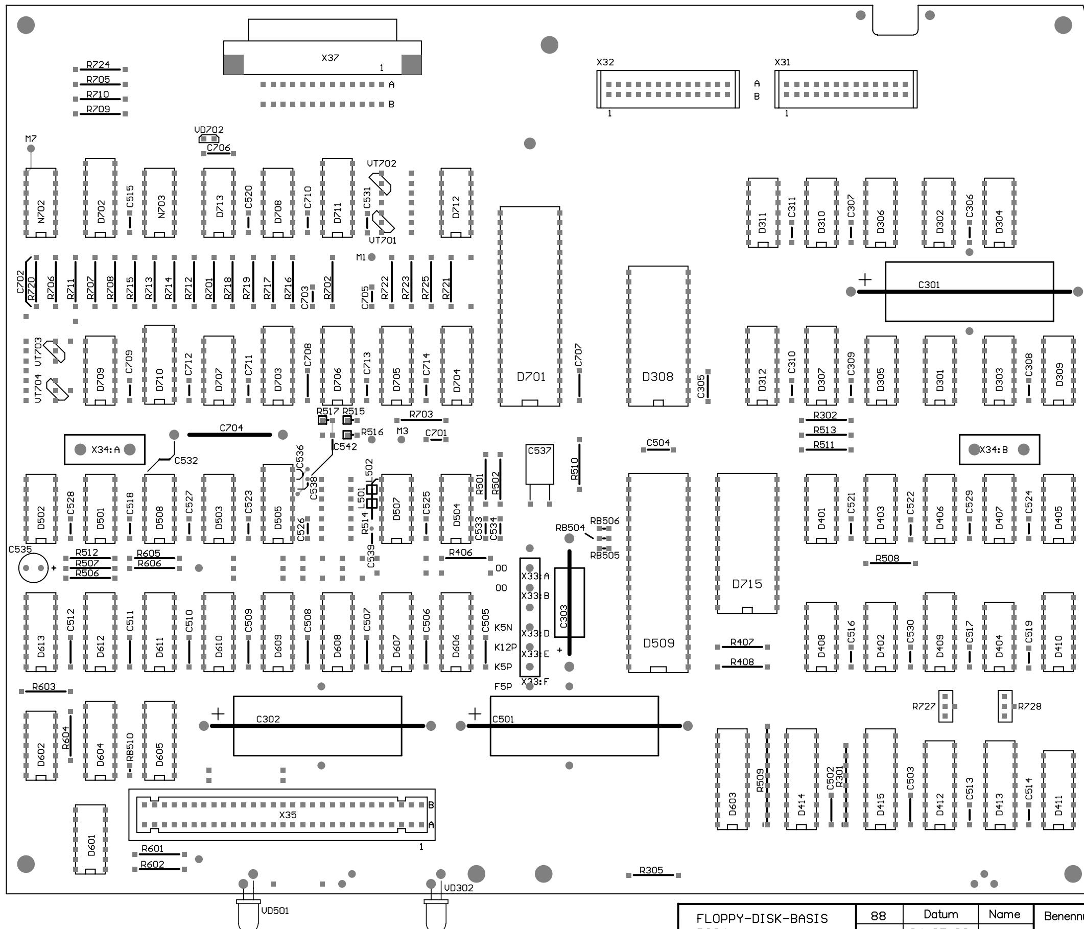
X37 mit Zylinderschraube BM2,5x14 befestigen
